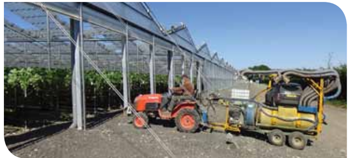
Los costos de mano de obra se pueden reducir incorporando sistemas de pulverización motorizados en las estructuras.
