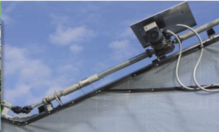
Los sistemas de apertura/cierre utilizan juntas universales de uso rudo
